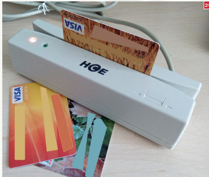
Рис. 21. Считыватель магнитных карт
