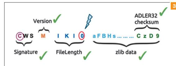
Первые два байта заголовка, которые нас интересуют, — это CMF и FLG. Первый байт, CMF (Compression Method and flags), делится на два четырехбитных поля: первое, CM [0:3], отвечает за метод компрессии, второе, CINFO [4:7], информационное, содержит информацию в зависимости от метода компрессии.
