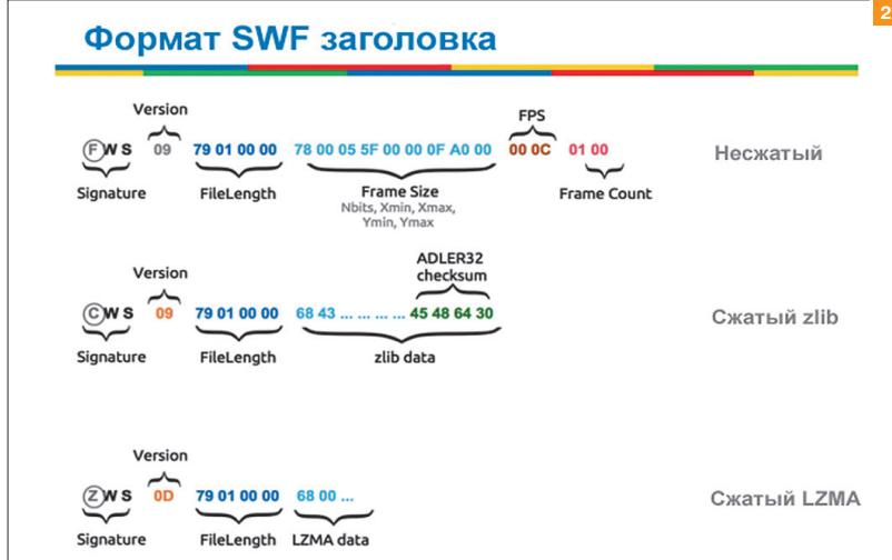
**Рис. 1.** Rosetta Flash принимает на вход обычный бинарный SWF и возвращает эквивалентный, сжатый zlib, состоящий только из буквенно-цифровых символов
