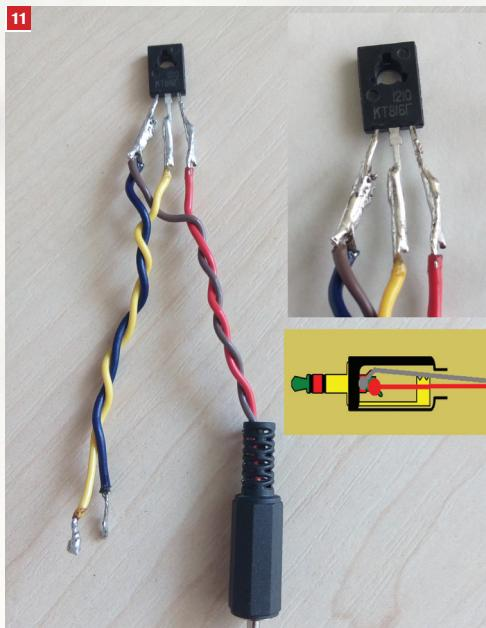
Рис. 11. Схема подключения для переходника
