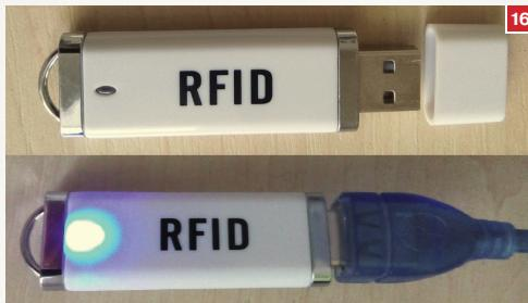
**Рис. 15 и Рис. 16. Дубликатор для RFID-карт**
